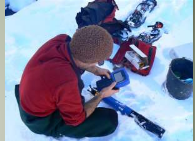
1 sonde multi-paramètres: Débit, Température, Ph, Fluorescence de l'eau, Conductivité à venir: Turbidité
